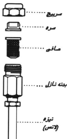
تصویر ۲۸: اجزای تشکیل دهنده نازل
